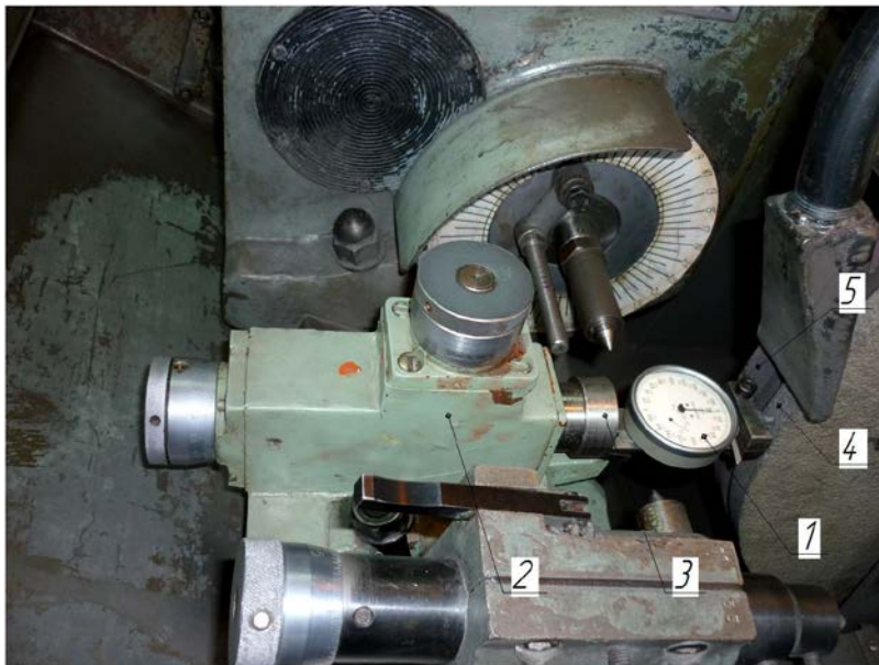
Рисунок 3.13 - Устройство для измерения радиального износа кругов
