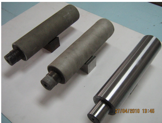
Рисунок 3.5 - Образцы для исследований износостойкости абразивных материалов при микрорезании
